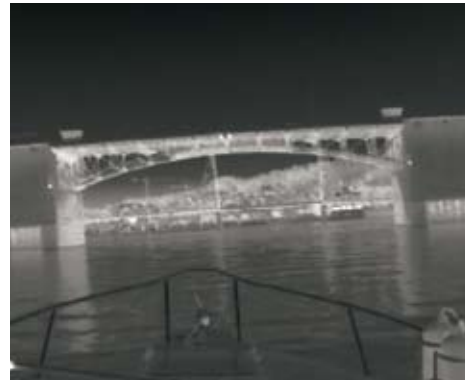
Instaladas en barcos, las cámaras térmicas generan una imagen clara en las noches más oscuras.
