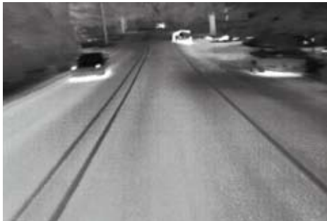
Las cámaras térmicas permiten a un conductor ver hasta 5 veces más lejos que con los faros.
