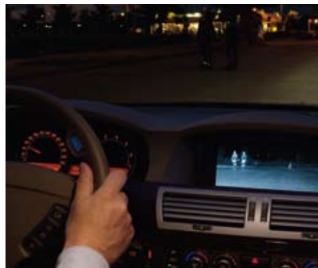
El sector de la automoción ha descubierto las ventajas de la termografía para la mejora de la visión del conductor.
