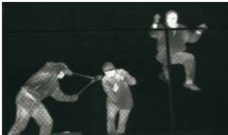
Las cámaras térmicas detectan muy fácilmente a los intrusos. No es necesario instalar un costoso sistema de iluminación.
