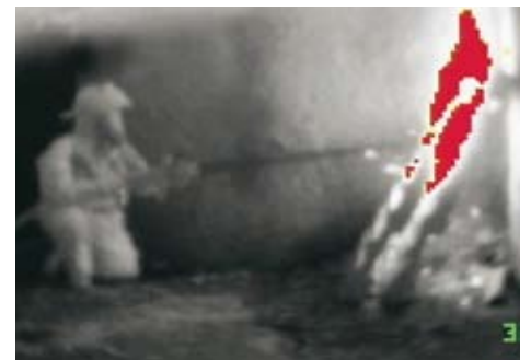
Las cámaras térmicas pueden ver a través del humo. Esto las convierte en una herramienta excelente para los bomberos
