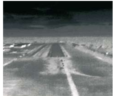
La termografía puede ayudar a los pilotos a despegar y aterrizar en oscuridad total.
