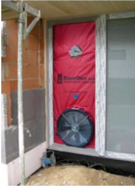
(izda) Test BlowerDoor en vivienda unifamiliar de nueva construcción
