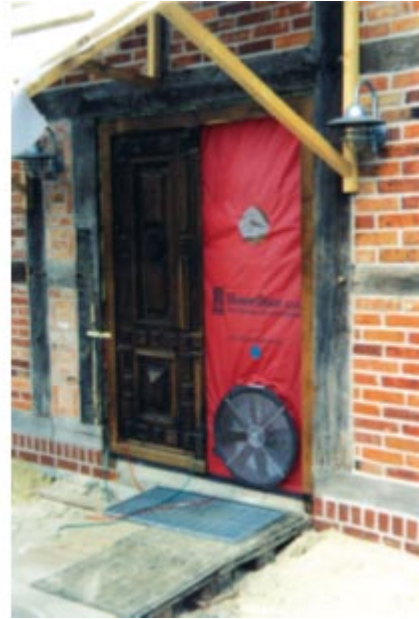
(izda) Test BlowerDoor en vivienda unifamiliar de nueva construcción
