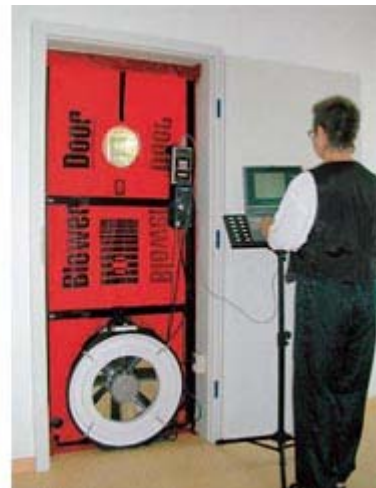
izda) El aislamiento es aún visible (planchas y paneles de madera): Este el momento óptimo para una medición BlowerDoor.
